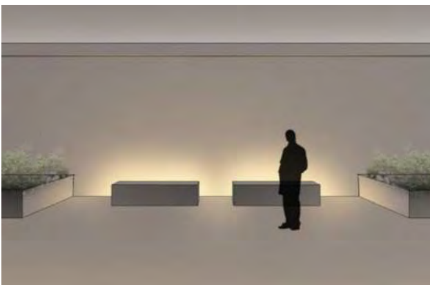
ベンチを利用した壁面間接照明
