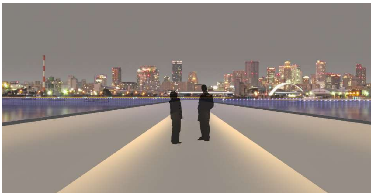
手摺照明 / 光源を見せない照明手法により、景色が美しく見える
